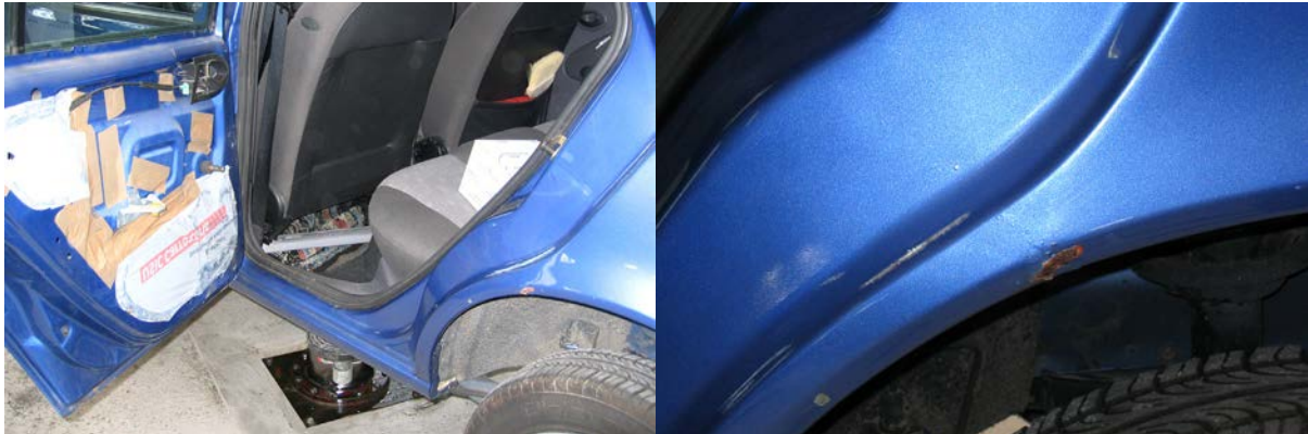
Abschnittsreparatur mit korrodiertem Übergang (Bild Flückiger)
