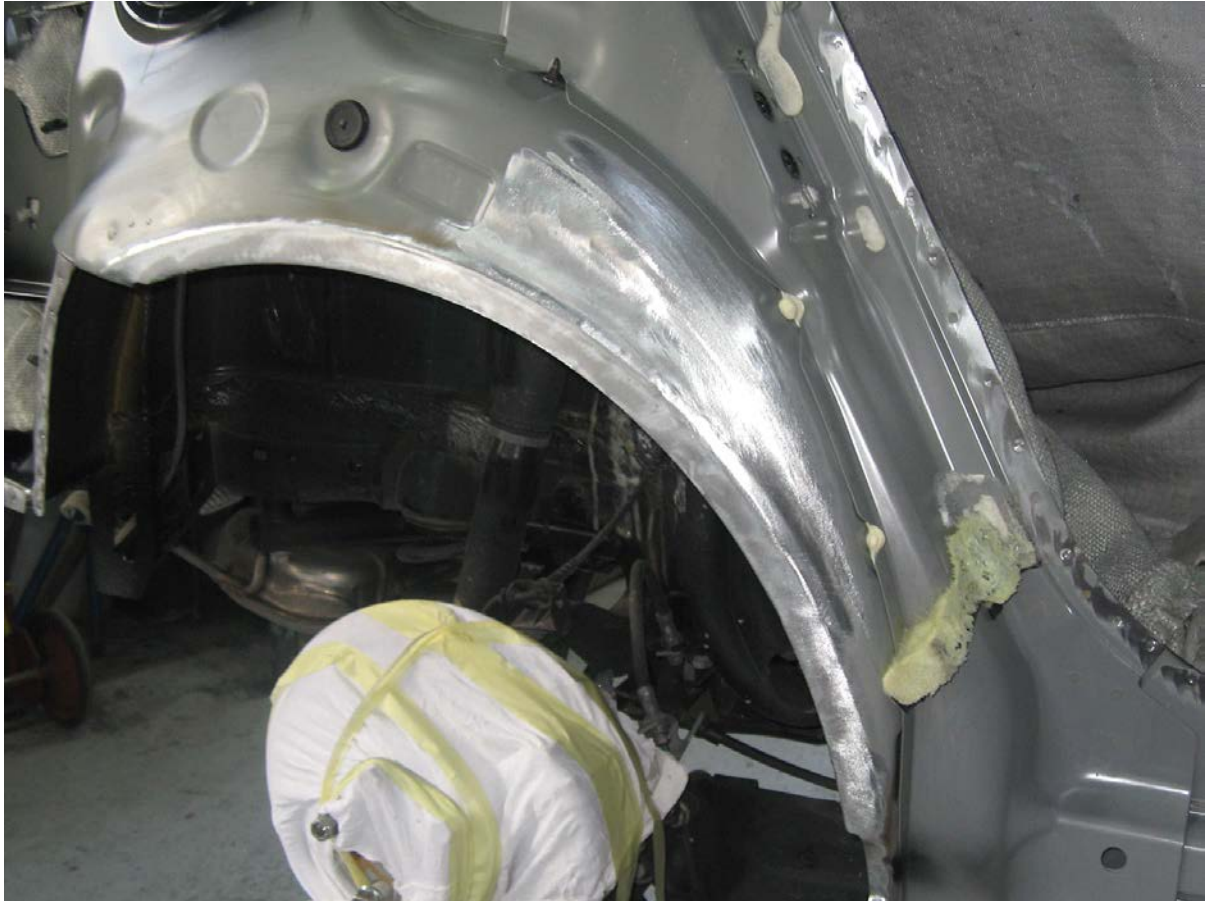
Bild: Nach dem Austrennen kann der Radkasten einwandfrei ausgebeult werden. Die Aufnahmepunkte der Seitenwand passen perfekt (Bild Fückiger)
