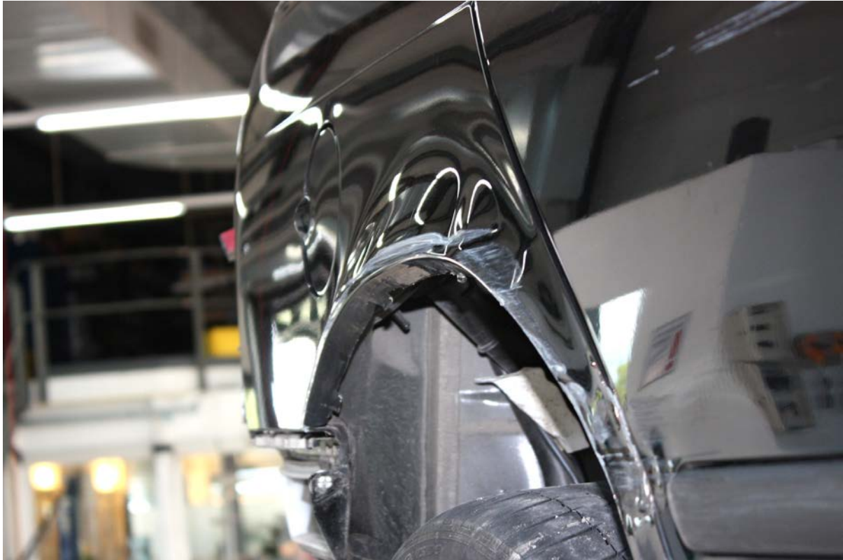
Bild: Die stark deformierte Seitenwand (Bild Flückiger)
