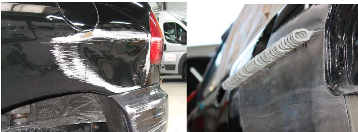
Bild : Ideales Schadenbild für eine Instandsetzung mittels Push-Pull-System (Bild Flückiger)
