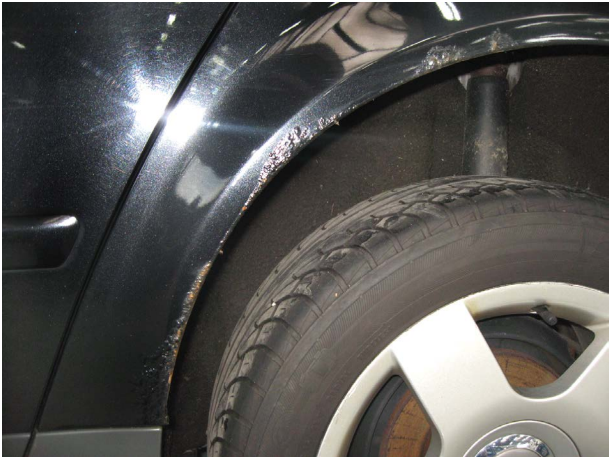
Auswirkungen einer mangelhaften Instandsetzung (Bild Flückiger)
