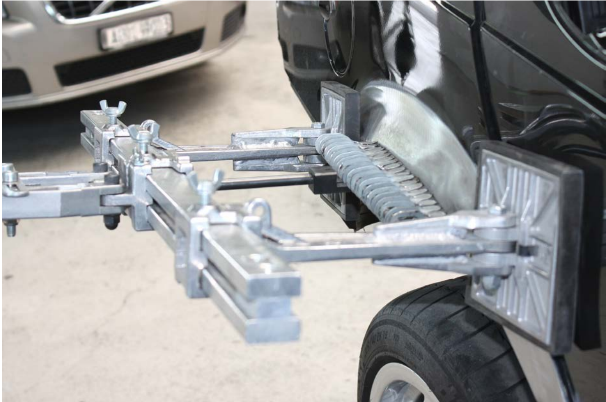
Bild: Ausbeulen mittels Push-Pull-System (Bild Flückiger)
